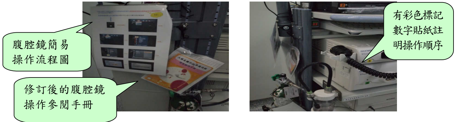
圖二、三 改善後的大腸直腸腹腔鏡有簡易操作流程圖及參閱手冊可供參考，且有彩色標記數字貼紙註明操作順序
